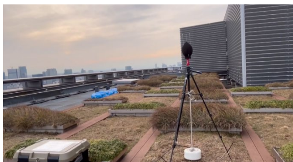
▲新丸ビル 34 階に設置された騒音計
