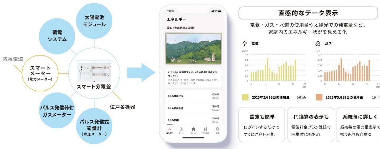
HOMETACT アプリから家庭内の電気・ガス・水道の使用量、太陽光発電の発電量や蓄電池の残量などエネルギー状況を簡単に確認でき、回路（系統）毎に計測できるスマート分電盤の機能を活かして、全体の買電/売電量に加え、冷暖房設備やエコキュートなどの個別接続された機器の電力量も確認することができます。時間単位や日・月単位でのグラフ表示切り替え、回路毎にユーザー側で名称設定・変更が可能な機能なども盛り込み、利用者がアプリ内でのエネルギー管理や利用状況に応じた節電行動につながるやすい環境を構築しています。
