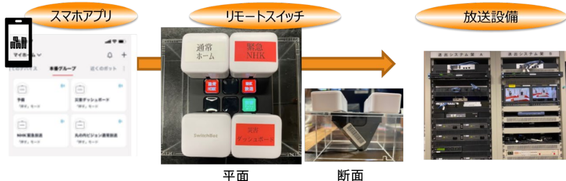
▲緊急切替器（リモートスイッチ）とスマホアプリによる遠隔操作の流れ
