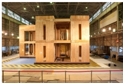
防災科学研究所における実物大建物の振動台実験
