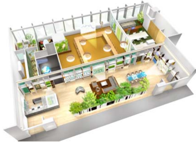
■大丸有地区環境戦略拠点「エコツェリア」 （千代田区丸の内1-5-1 新丸の内ビル10階） オフィス部分：約80㎡ 就業者数：11名 照明灯数：24灯 計測期間：2009年10月～2011年1月 （1年分の収集データより分析を実施）
