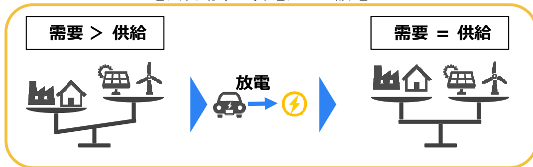
電気自動車の蓄電池から放電
